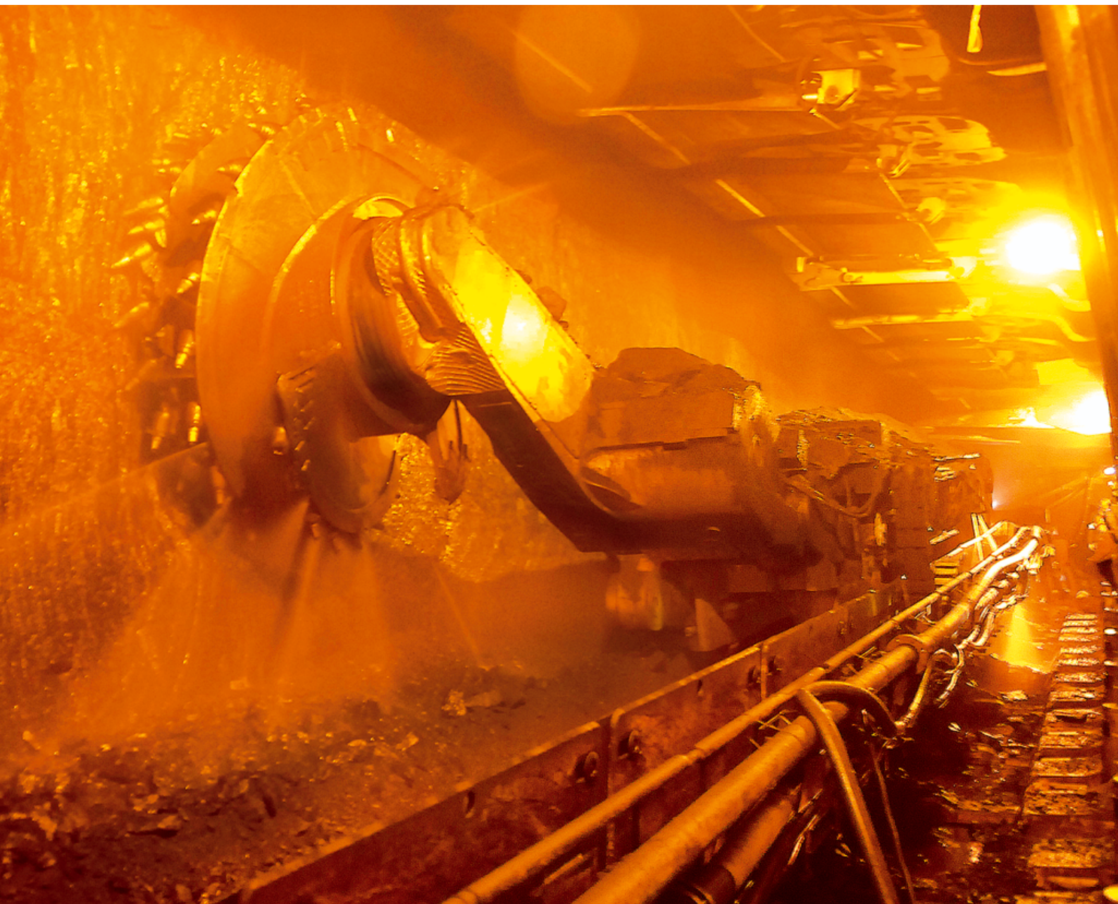
井工矿综采工作面
